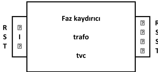
Bir faz kaydırıcı trafo kullanıldığı takdirde, deney tertibatı aktif enerji sayacı için düzenlenmiş olduğu halde reaktif enerji sayacını aktif sayaç gibi kolayca kontrol etmek mümkündür.
